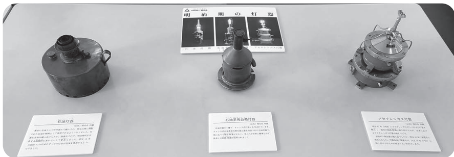
左から石油灯器、石油蒸発白熱灯器、アセチレンガス灯器
