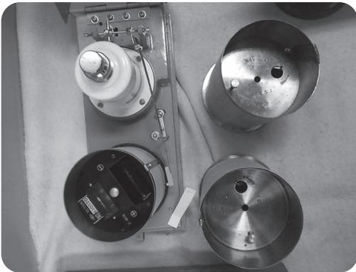
写真5 気象観測用気圧計
