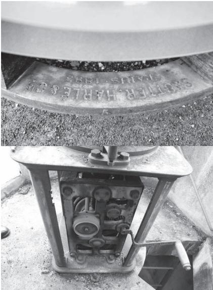
写真-11 レンズ台座の刻印と回転装置
