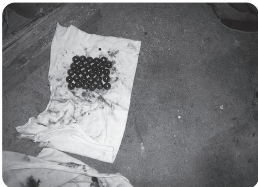
鋼球の摩耗計測
