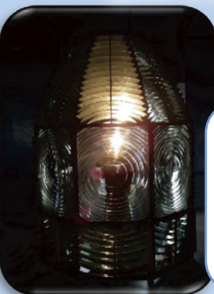
犬吠埼灯台初代レンズ 「第一等8面フレネル式せん光レンズ」 明治天皇皇后陛下にご覧いただきました
