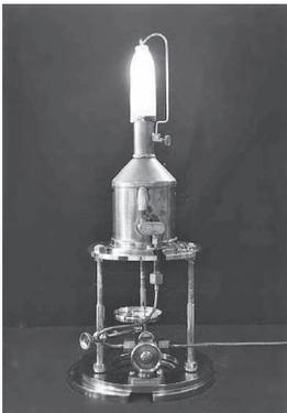
写真-1 チャンス式石油蒸発白熱灯器
